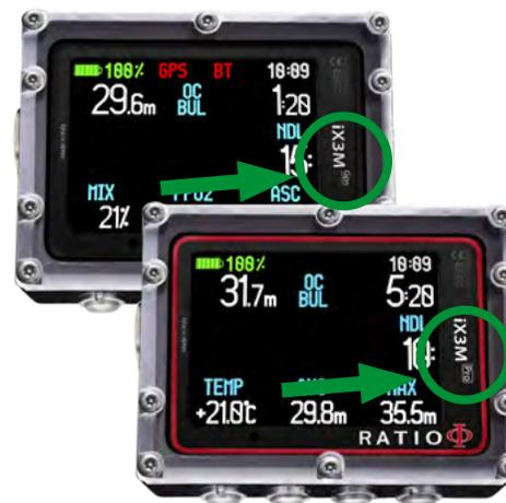
I dispositivi iX3M sulla cui mascherina è riportato "iX3M" unitamente alla dicitura "Gps" oppure alla dicitura "Pro" sono compatibili con la Sonda CC
