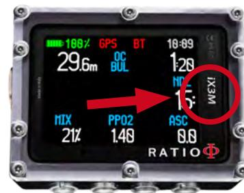
I dispositivi iX3M sulla cui mascherina è riportato unicamente "iX3M" **non** sono compatibili con la Sonda CC
