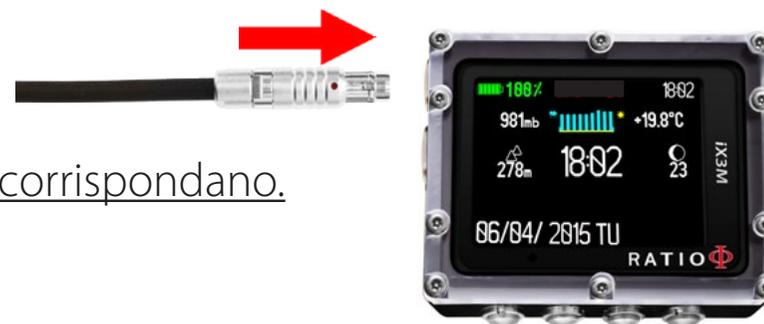
Per scollegare il connettore è necessario spingere il connettore verso l'iX3M (in modo da liberare la sicura) e successivamente tirare dolcemente per eseguire la disconnessione. (Attenzione, manovrare il connettore, non tirare il cavo)
