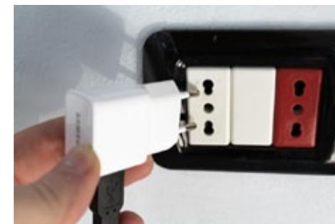
E' consigliabile utilizzare una presa di corrente USB a muro (come quella del tuo telefonino/tablet) per ricaricare l'iX3M. Nel caso si decidesse di utilizzare una presa USB di un PC assicurarsi che il PC non interrompa il flusso di corrente quando in stand-by.
