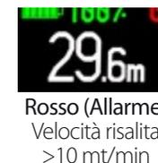
**Profondità attuale:** (sinistra) Con codice di allarme colore al superamento della MOD del gas, della sosta obbligatoria, dell'allarme di profondità.)
