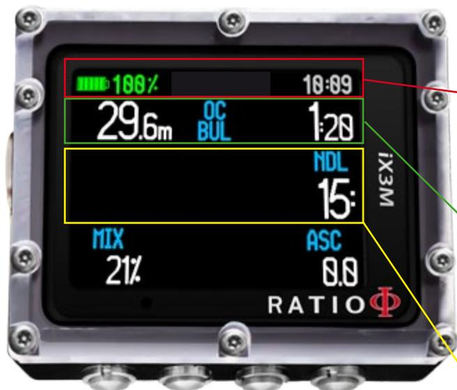
**BATTERIA:** % di batteria residua.
