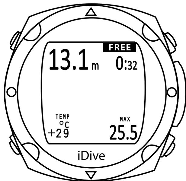
Durch Drücken der Taste B bekommen Sie links die aktuelle Wassertemperatur und rechts die maximale Tiefe der aktuellen Serie angezeigt.
